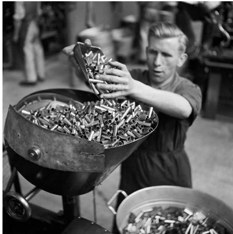
Munitionsherstellung in der Eidgenössischen Konstruktionswerkstätte Thun, 1941. Ein Arbeiter füllt Patronenhülsen um.
